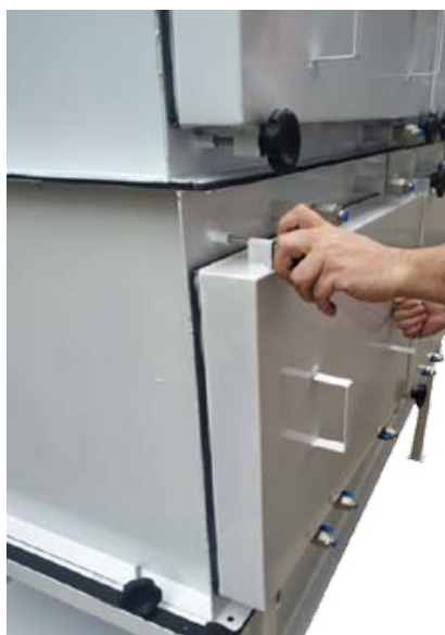
Parte externa porta de acesso Figura 1-2.
