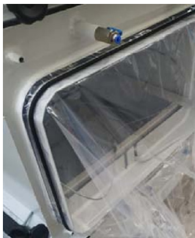
Caixa vazia representando o anel do saco e a haste de recuperação do filtro Figura 1-1.
